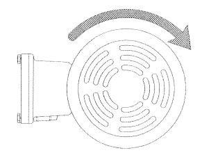
CRUSHER MOTOR ROTATION BLOWER MOTOR ROTATION
